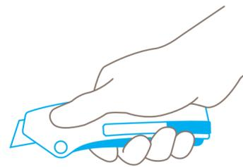
Um die **Klinge auszulösen**, Sicherung entriegeln und Hebel betätigen. Jetzt können Sie schneiden.
