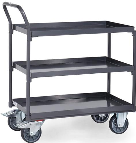
Stahlkonstruktion, geschweißt. Mit 3 Stahlblechwannen. Stahlrohrbügel und Stahlblechwannen verschraubt. Wannen öldicht, Rand 40 mm hoch. Elektrisch leitfähig pulverbeschichtet schiefergrau RAL 7015. Schiebegriff waagrecht. 2 Lenk- und 2 Bockrollen, TPE-ESD-Bereifung, Naben mit Rillenkugellager. Feststeller an den Lenkrollen, gemäß EN 1757-3 (Sicherheit von Plattformwagen). Tragkraft obere Ladefläche 200 kg.
