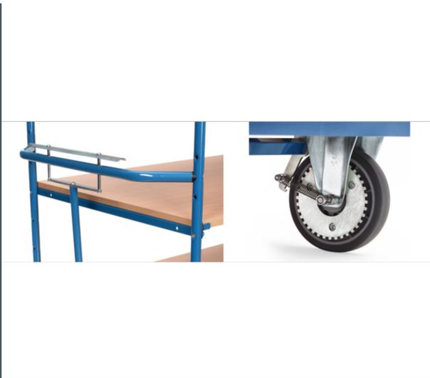
Kompakte und leichte Feststellbremse für alle Wagen mit 2 Bockrollen und serienmäßiger TPE-Bereifung bis 600 kg Tragkraft. Betätigungsleiste am Schiebegriff losgelassen = Bremse fest, Wagen ist zuverlässig gegen Wegrollen gesichert. Betätigungsleiste gedrückt = Bremse gelöst, Wagen lässt sich leicht verfahren. Ergonomische und leichtgängige Handhabung. Sichere Bremswirkung durch formschlüssige Sperrverzahnung. Nicht als Fahrbremse geeignet. Mehrpreis pro Wagen. Nicht nachrüstbar.
