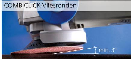
Mit COMBICLICK werden Kratzer durch hervorstehende Spannteile vermieden und eine sehr hohe Ausnutzung des zur Verfügung stehenden Schleifmittels erzielt.
