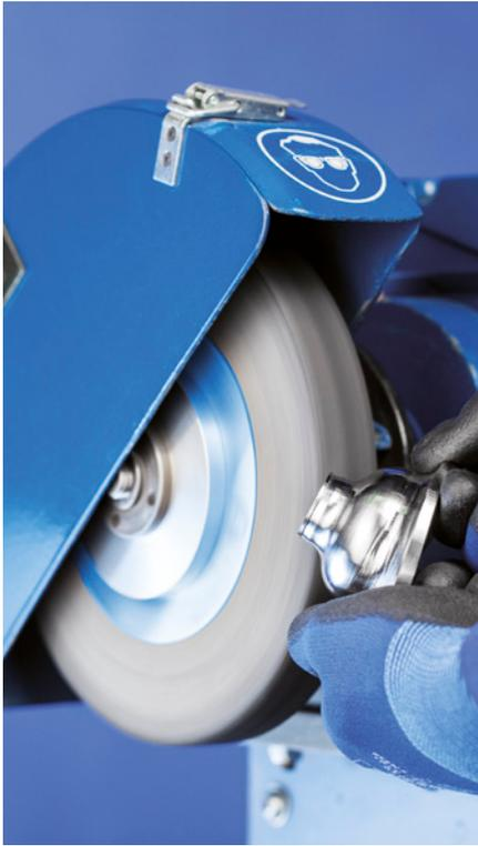
Vlieswerkzeuge PNK bestehen aus spiralförmig um einen Kern gewickeltem und aufgeschäumtem Schleifvlies. Der Schaum stützt das Vlies und beeinflusst dessen Standzeit und Schleifverhalten. Durch diese spezielle Bindung entstehen Vliesräder mit sehr gutem Oberflächenfinish, hoher Abtragsleistung und hoher Standzeit.
