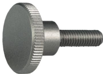
Rändelschrauben sind aus einem Stück hergestellt. Entgegen dem Normblatt sind sie generell mit Gewinde bis zum Kopf und ohne Einstich am Gewindeende gefertigt.
