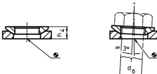
\* Rändel: Materialkennzeichnung für Ausführung rostfreier Stahl A4
