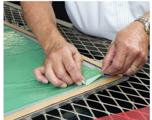
Arbeitet innerhalb des Packbereichs, um Laminatlagen, Trennfolien, Packmaterialien und Thermolemente sicher zu halten/zu positionieren und gleichzeitig eine saubere Entfernung nach der Aushärtung zu gewährleisten.
