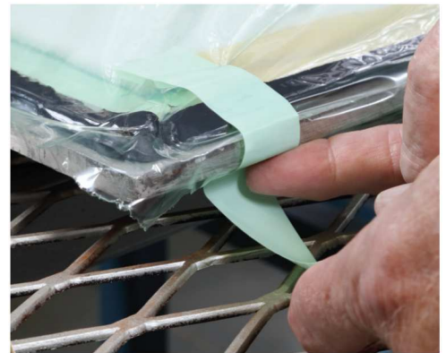
Arbeitet außerhalb des Packbereichs, um Laminatlagen, Trennfolien, Packmaterialien und Thermolemente sicher zu halten/zu positionieren und gleichzeitig eine saubere Entfernung nach der Aushärtung aus dem Fertigungswerkzeug zu gewährleisten.
