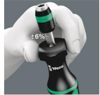
Messgenauigkeit  $\pm 6\%$  nach Norm DIN EN ISO 6789. Deutlich hör- und spürbares Überrassten beim Erreichen des eingestellten Drehmoments.
