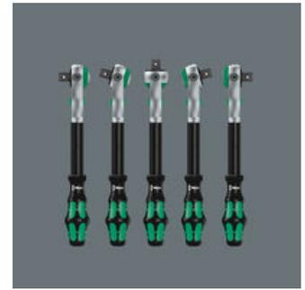
Der Knarrenkopf ist frei schwenkbar und kann durch den beidseitig angebrachten Schiebeschalter in jeder Fixierungsposition verriegelt werden. Problemloses Arbeiten mit großem Handfreiraum ist selbst in sehr engen oder schwer zu erreichenden Einbausituationen möglich. Die definierte Fixierung bei 0°, 15° und 90° nach links und rechts garantiert sicheres Arbeiten ohne Verrutschen des Knarrenkopfes.
