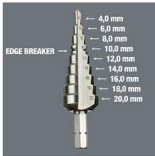
9 Bohrstufen 2 mm steigend, einsetzbar in Material bis 4,5 mm Stärke. Mit Kantenbrecher (Blechentgrater) am Ø 10 für 1 mm Bleche
