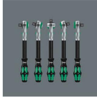
Der Knarrenkopf ist frei schwenkbar und kann durch den beidseitig angebrachten Schiebeshalter in jeder Fixierungsposition verriegelt werden. Problemloses Arbeiten mit großem Handfreiraum ist selbst in sehr engen oder schwer zu erreichenden Einbausituationen möglich. Die definierte Fixierung bei 0°, 15° und 90° nach links und rechts garantiert sicheres Arbeiten ohne Verrutschen des Knarrenkopfes.
