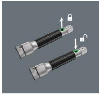
Die Verlängerungen der Top-Linien sind mit dem Flexible-Lock-System ausgestattet. Mit aktiviertem System können die Betätigungswerkzeuge dauerhaft auf der Verlängerung gesichert werden. Ungewollter Verlust des Werkzeugs oder Herausrutschen wird vermieden. Ist das System deaktiviert, können die Nusskörper wie gewohnt aufgesteckt und blitzschnell gewechselt werden.
